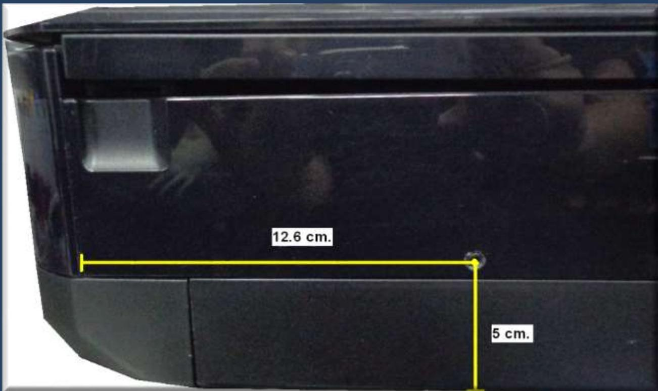
► Haga una perforación sobre el lateral derecho de la impresora, a la altura señalada.
