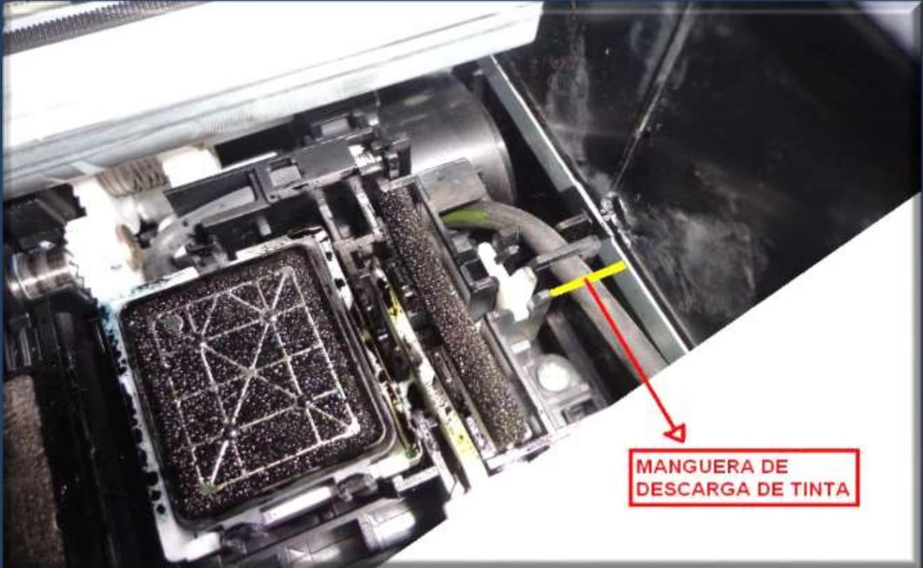
**¡ATENCIÓN!** LEVANTE LA TAPA DE LA IMPRESORA, ENCIENDALA Y CUANDO EL CARRO SE ESTÉ DESPLAZANDO DESENCHUFELA. EL CARRO QUEDARÁ LIBERADO PARA PODER DESPLAZARLO MANUALMENTE. DESPLACE EL CARRO HACIA LA IZQUIERDA Y LOCALICE LA MANGUERA QUE SEÑALA LA FOTO (ESTA MANGUERA ESTA HACIA EL LATERAL DERECHO DE LA IMPRESORA).
