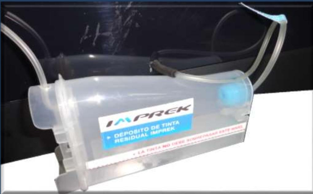
► Conecte el extremo de la manguera al tanque externo de tinta.
